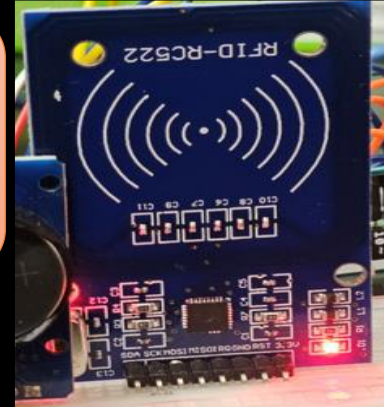
RFID Tag and MFRC522 RFID reader module
